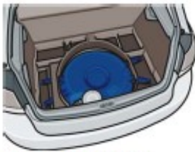
Der Flüssiggastank in der Reserveradmulde (Beispiel Golf)
